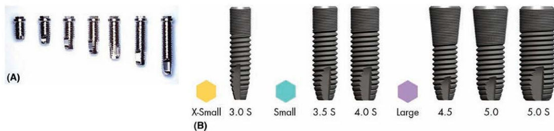
Hình 1.4: (A) Implant Branemark trong thang chiều dài từ 7-20mm. Bề mặt Implant được cắt bằng máy hoặc tiện, phần đầu implant có đỉnh phẳng và kết nối hình lục giác bên ngoài. (B) Thang độ Implant của Astra Tech có đường kính từ 3.0 đến 5.0 mm. Implant đường kính lớn có cổ dài hơn được tạo ren.
