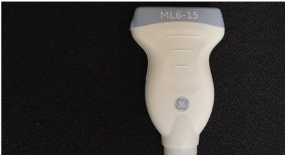
Hình 2.1 Mẫu đầu dò thẳng dải tần rộng (linear).
