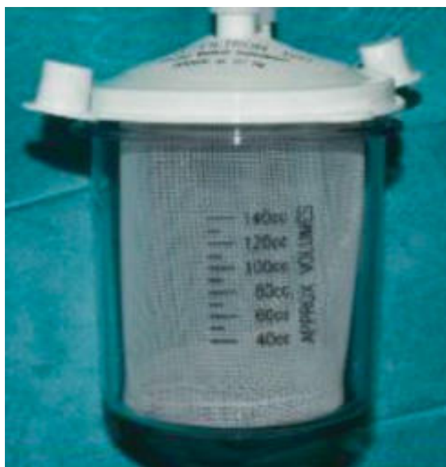
Hình 6.9 Chi tiết bộ lọc với các lỗ có đường kính 800 \mu\text{m}
