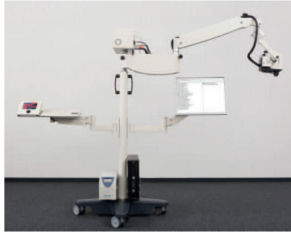
Hình 3.11 Hình ảnh của hệ thống chụp OCT (OCT) khung Heidelberg Spectralis với Flex Module, đây là một thiết bị đang trong giai đoạn thử nghiệm. (In với sự cho phép của Heidelberg Engineering.)
